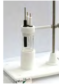
A : for OD 6mm electrode B : for OD 4,6mm electrode
