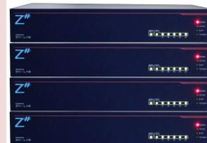
4台Z#106可以测量20个电解池，或者19个电解池与一个总燃料电池堆（或电池组）的EIS。
