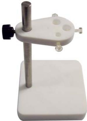
UEH1型通用电极支架，设计用于夹持各种尺寸的电极。UEH1有4个孔用来夹持电极，其中三个孔可以通过螺丝调节孔的尺寸。孔的直径从1.6mm到10mm直径。底板材料为Teflon®，具有非常高的耐化学腐蚀性，白色的材质可以帮助用户轻易识别出实验过程中样品的微小变化。
