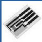
ZIVE SP1 电化学工作站可用于研究采用DNA芯片或丝网印刷电极的传感器。系统的最小电流量程为1nA。循环伏安，计时电流和EIS测量技术可以应用在传感器的研究中。
