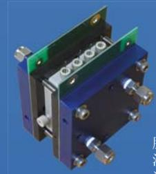
膜电导电解池与燃料电池硬件支架
