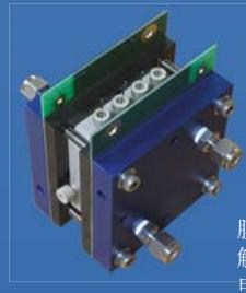
膜电导率电解池带燃料电池支架
