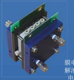
膜电导率电解池带燃料电池支架
