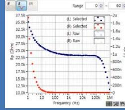
R<sub>p</sub>, C<sub>p</sub> vs 频率 (R/C)
