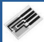
ZIVE MP5H电化学工作站可用于研究采用DNA芯片或丝网印刷电极的传感器。系统的最小电流量程为10pA。循环伏安，计时电流和EIS测量技术可以应用在传感器的研究中。
