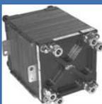
ZIVE MP2A电化学工作站理想应用于表征研究开发级别的燃料电池和阳极助阴极过程的机制。本系统可直接应用于PEMFC，DMFC，DEFC等类型燃料电池的测试。FRA模块可控制外部电子负载用于燃料电池的阻抗测量。提供完全电流量程的I-V曲线测量（选择自动量程I-V扫描确保高精度连续的测量）。
