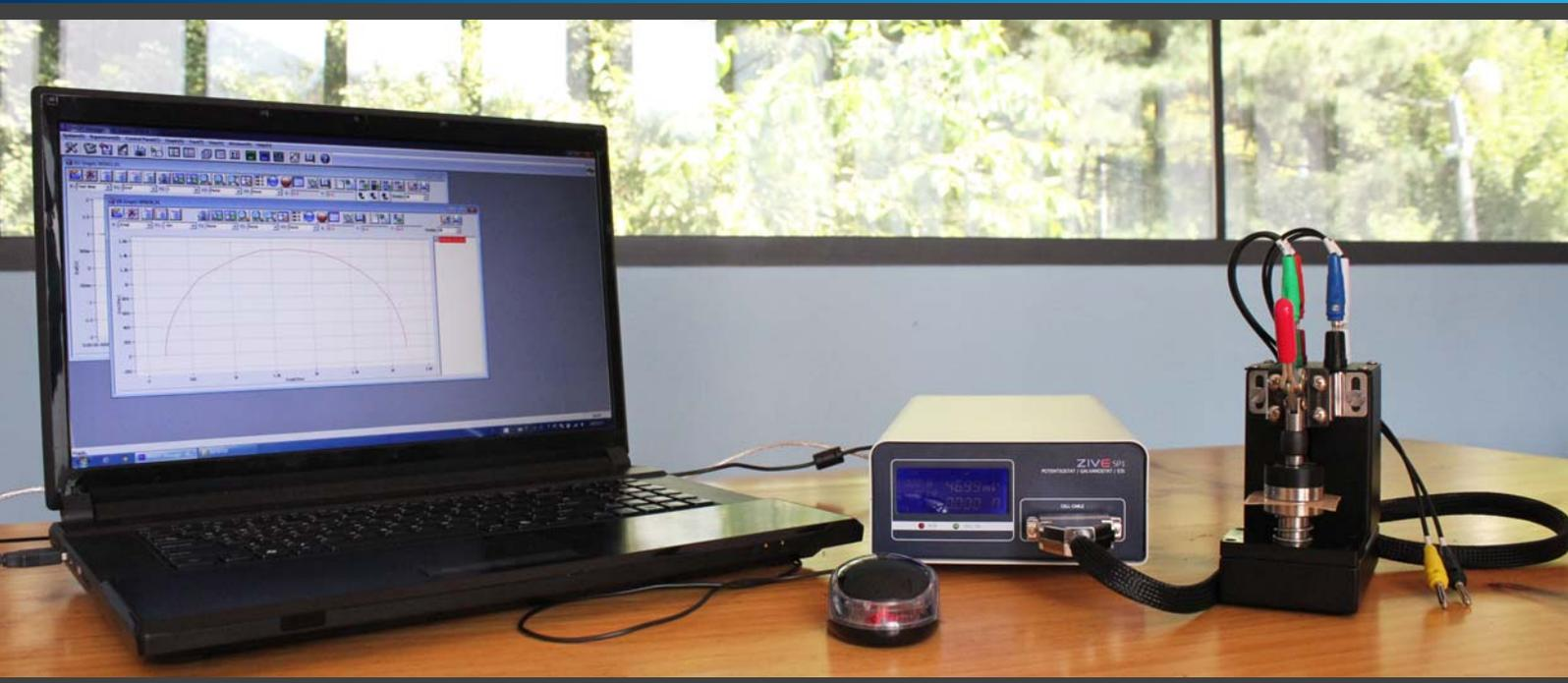
由于材料的导电性与欧姆损耗直接相关，所以为了评价一种新型合成材料(如离子交换膜 IEM 和质子交换膜(聚合物电解质膜， PEM)的性能，离子电导率的测量至关重要。
