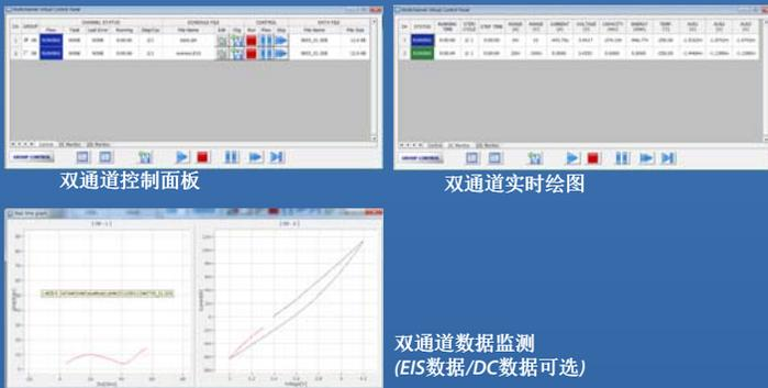
用户可以详细控制和监测某个指定的通道，还可以监测兴趣值窗口的数据，并在同一窗口监测通道的状态。实时图形的X, Y轴格式随着测试技术的不同而自动更改为最常用的格式。也可以根据用户需要自定义更改坐标轴格式。
