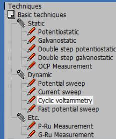
通过步骤控制功能，上述测试技术可以顺序执行。
